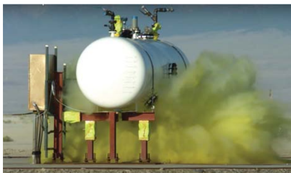
Obr. 1. Okamžik zahájení masívního úniku chloru ze zásobníku (cca 0,5 sekundy od zahájení úniku) 8
