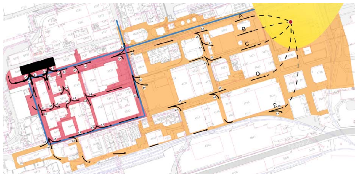
Obr. 9. Ilustrativní příklad určení toku jednotlivých proudů oblaku těžkého plynu šířícího se uličními kaňony v průmyslovém podniku
